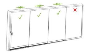
F) Schiebe die Gläser zur Seite, richte den Zentriersockel und die Distanzhülse genau an diesen Markierungen aus und nutze den Sockel mit Hülse als Bohrhilfe, um mit dem Schrauben inkl. Bohrspitze das Alu perfekt zentriert vorzubohren.
